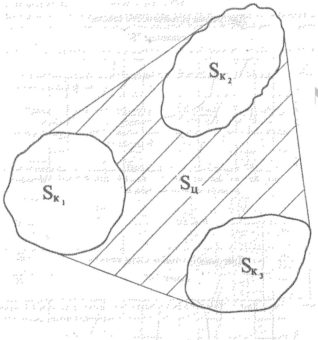
**Схема к определению расчетного коэффициента извлечения междукамерного целика.**
