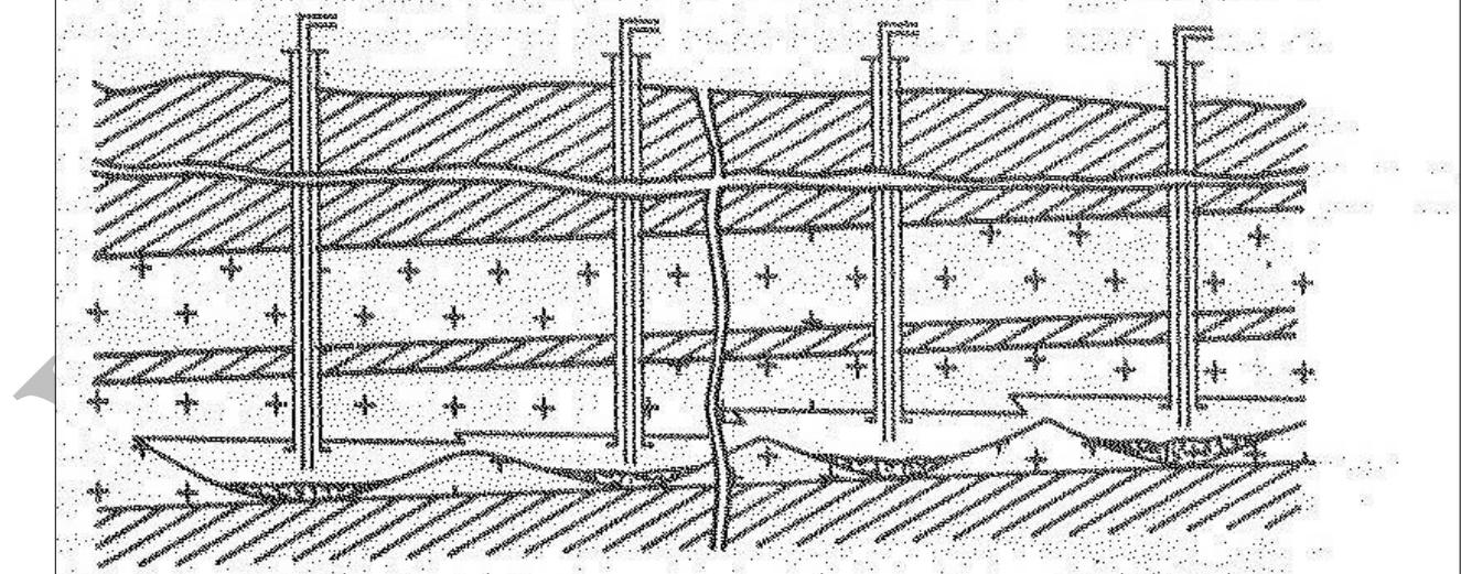
**Рис.6. Схема разработки сплошным растворением при обводке подготовительных камер размывом**
